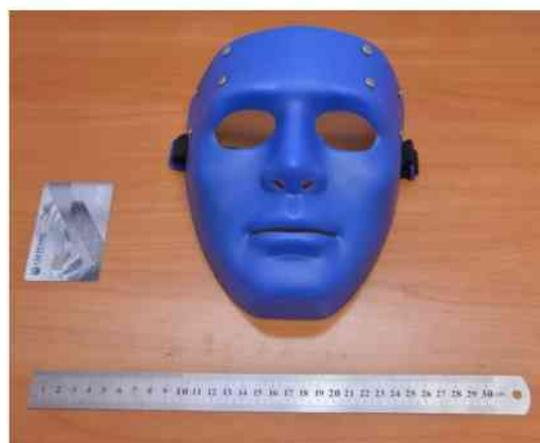
Рисунок 4 - Внешний вид воздействующей части ТЭС для проведения тепловых косметологических процедур на лицо
