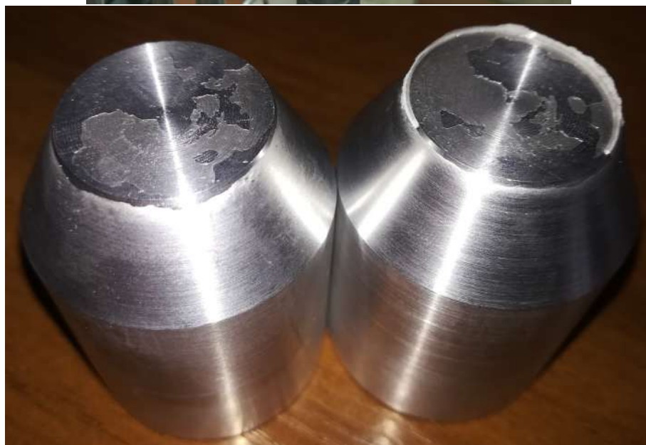
Рисунок 6.19 — Результат проведения эксперимента: уровень нагрузки в момент разрушения, кН (а) и адгезионное разрушение на поверхности алюминиевых образцов (б)
