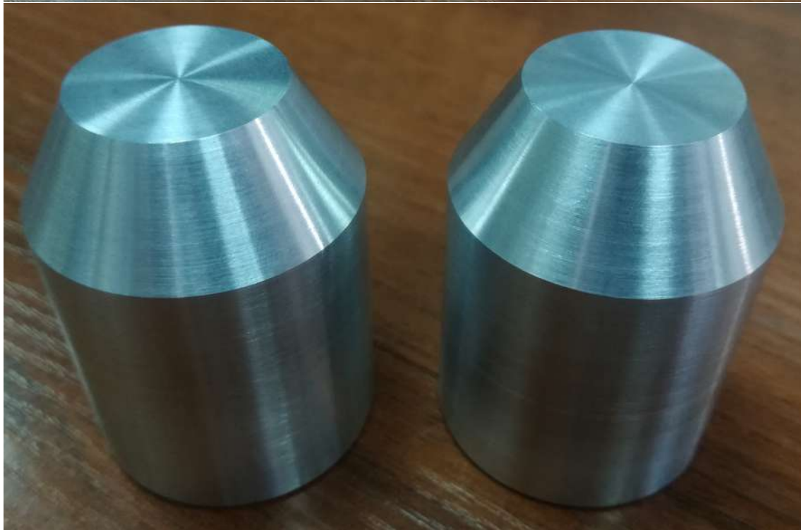
Рисунок 6.14 — Алюминиевая болванка (а) и заготовки из неё (б)
