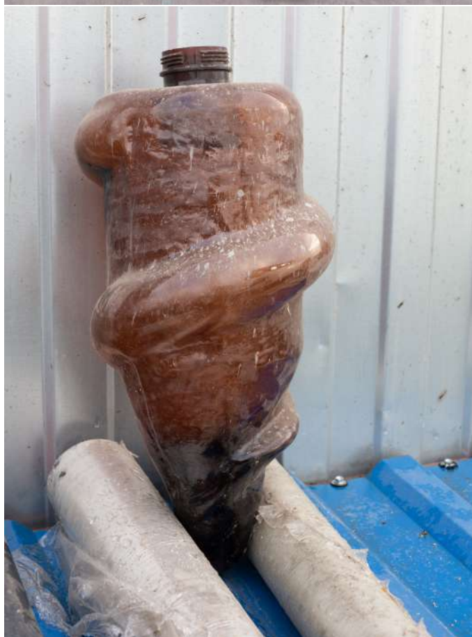
Рисунок 2.20 — Заготовки из полиэтилентерефталата: а — заготовка; б — готовый оголовок сваи
