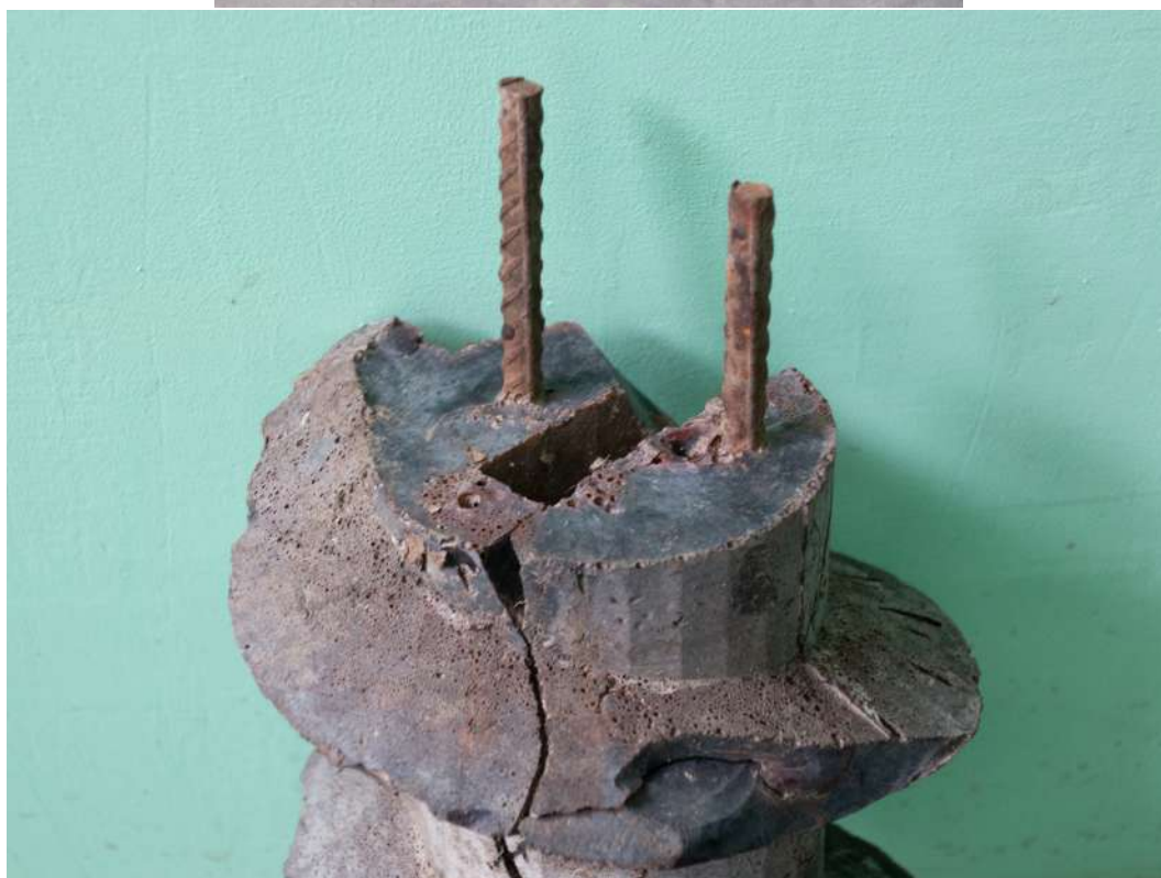
Рисунок 2.18 — Сваи из эпоксидной смолы: а — рабочая часть сваи; б — разрушение рабочей части сваи
