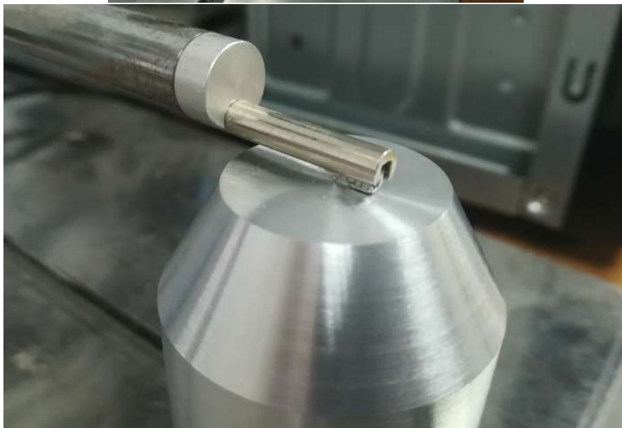
Рисунок 6.15 — Определение шероховатости поверхности цилиндрических образцов: а — профилометр модели 130; б — проведение испытания
