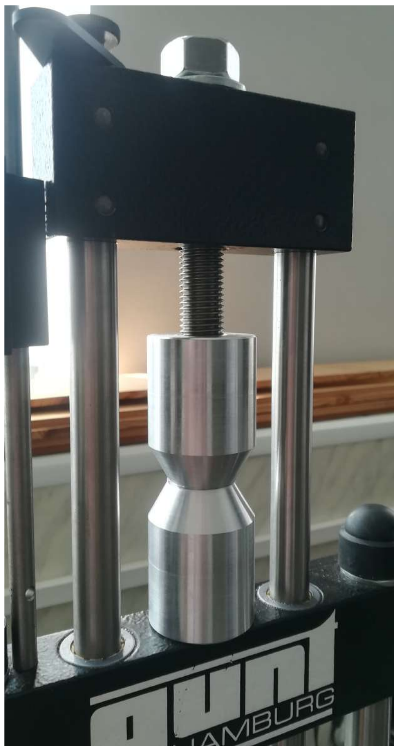
Рисунок 6.17 — Универсальная испытательная машина WP-300 с компьютерной системой сбора и обработки данных GUNT
