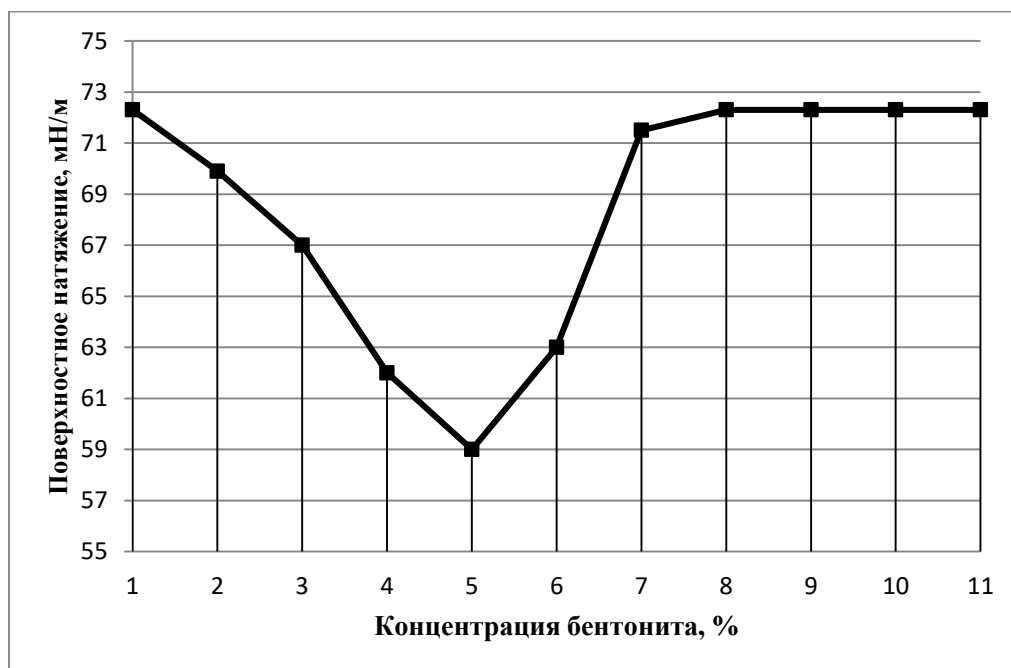
Рисунок 3.9. Изменение поверхностного натяжения воды от изменения концентрации твердой фазы в системе вода-бентонит
