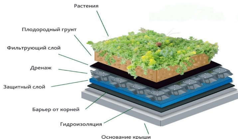
Рисунок 2. - Схема зеленой кровли.
