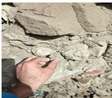
Рисунок 2 – Отбор образца раствора для анализа состава
