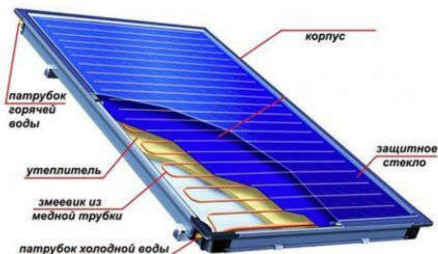
Рисунок 2 - Плоская солнечная панель (коллектор)
