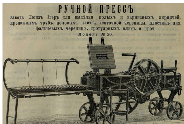
Рисунок 3. Ручная формовочная машина для производства керамической черепицы завода Люизъ Эгеръ XIX века (фото из общедоступной сети интернет)
