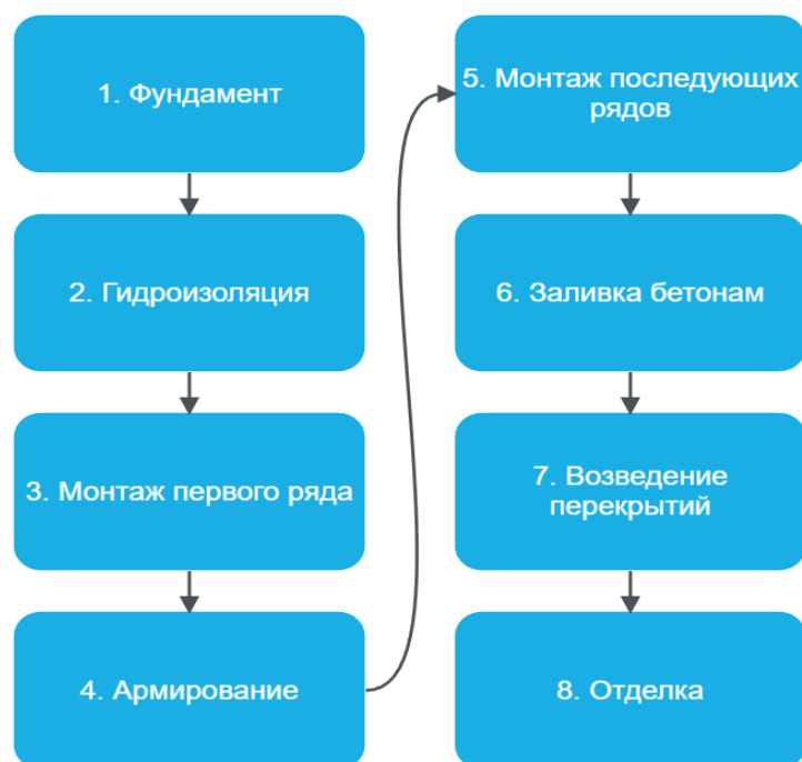
Рисунок 1. Этапы возведения здания из несъемной опалубки
