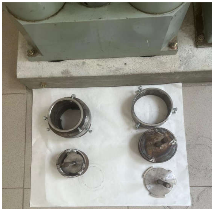
Рисунок 3. Вид дополнительных насадок для определения усилия сцепления и растяжения
