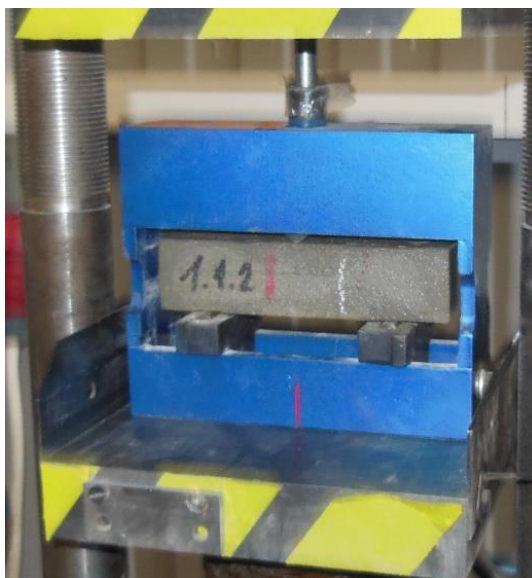
Рисунок 2.1 – Испытание на изгиб образцов-балочек (СИ-2-100-УХЛ4.2.)
