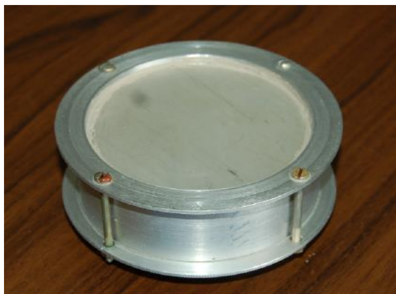
Рисунок 6.18 - Конструкция устройства для охлаждения элементов РЭА, работающих в режиме повторно-кратковременных тепловыделений с несколькими рабочими веществами
