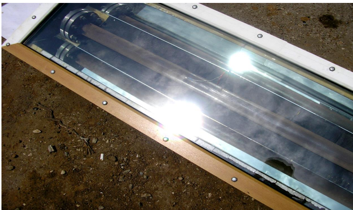
Рисунок 3.11 – Экспериментальная конструкция генератора-адсорбера гелиоэнергетической холодильной установки
