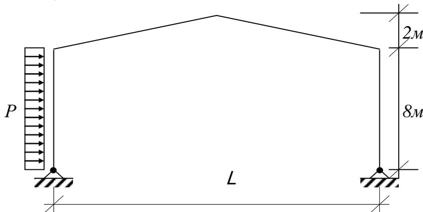
4. Построить эпюру  $M_k$  и определить реакцию опоры А (рис.5).
