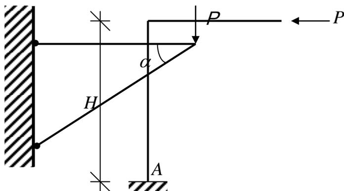
9. Построить эпюры  $M$  и  $Q$  (рис.12.). Дано:  $P=6\text{кН}$ ;  $L=4\text{м}$ .
