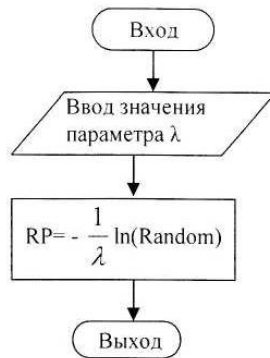
Рис. 2.4. Генератор случайных чисел RP ( \lambda ), соответствующий показательному закону с параметром \lambda .
