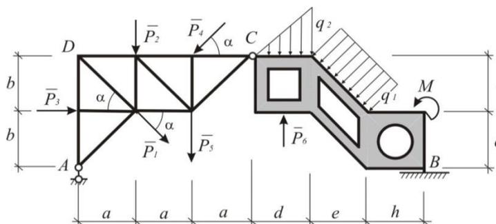
для конструкции в целом и для фермы и пластины в отдельности. Распределённую нагрузку заменить равнодействующей.
