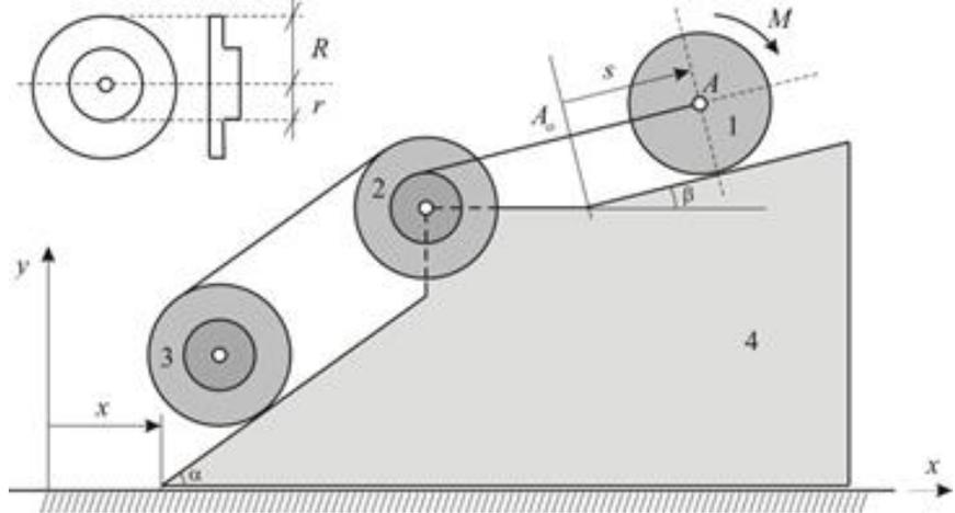
$m_1 = 2m$  радиуса  $r_1 = 2r$ . Блок 2 и каток 3 – одинаковые сплошные однородные двойные цилиндры массы  $m_2 = m_3 = m$  во внутреннем радиусом  $r_2 = r_3 = r$  и наружным радиусом  $R = R = 2r$ . Даны моменты инерции центров:  $J_2 = J_3 = \frac{3}{2}mr^2$ .
