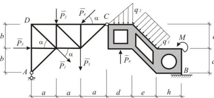
Часть 2. Определение усилий в стержнях фермы.
