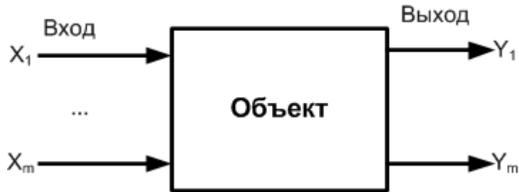
Рис. 6.5. Объект с несколькими входами и выходами
