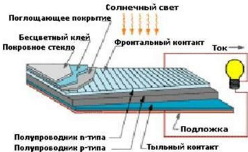
Рис. 4.6. Конструкция фотоэлемента
