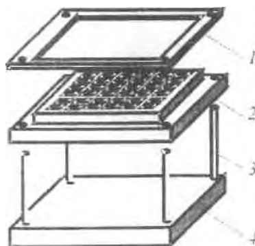
Рис. 22. Схема сборки модуля: 1 - направляющая рамка; 2 - матрица; 3 - направляющие штифты; 4 - основание
