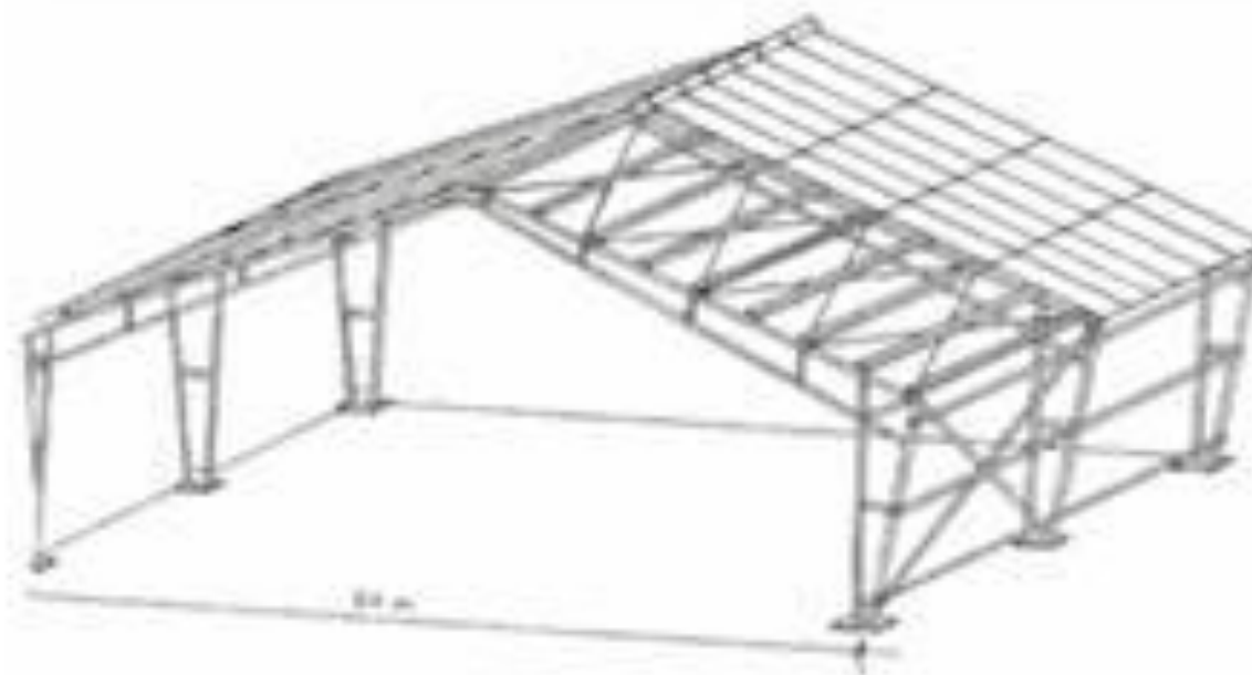
Рис.8. Каркас складского здания с деревянными клеефанерными рамами
