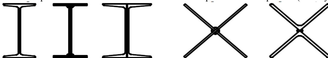
Рис. 13.1. Открытое сечение стержня колонн.
