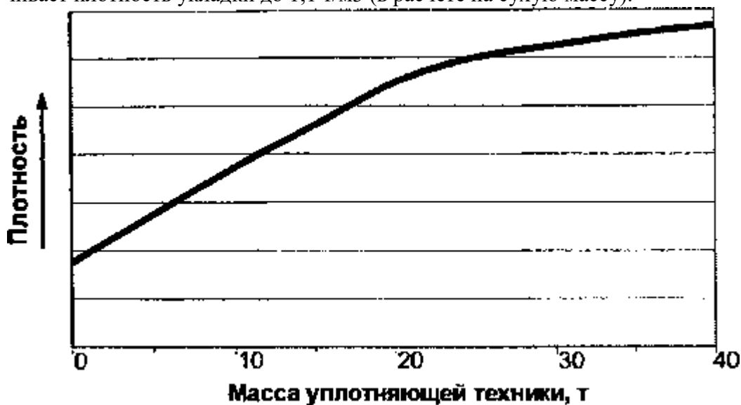
Рис. 3.6. Влияние массы уплотняющей техники на уплотнение ТБО
