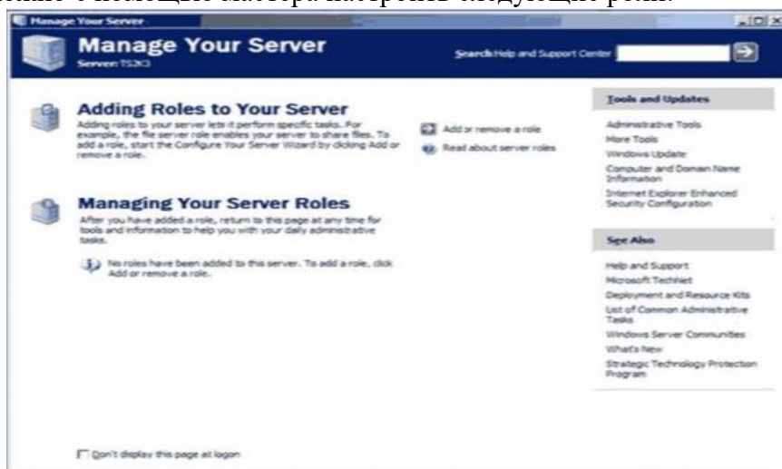
Рисунок 1 - Установка ролей Роль - это функция сервера (например, почтовый сервер, контроллер домена).
