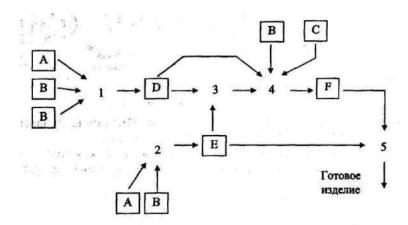
Например, операция 1 связана со сборкой узла D, состоящего из одного узла A и двух узлов B, она может начаться только при наличии этих узлов на участке сборки. Операции 1 и 2 могут выполняться одновременно (разными рабочими), операция 3 связана с приведением в соответствие (подгонкой) узлов D и E, она может начаться только при готовности обоих узлов. Операция 4 может выполняться только после операции 3 и т. д. (см. рисунок)
