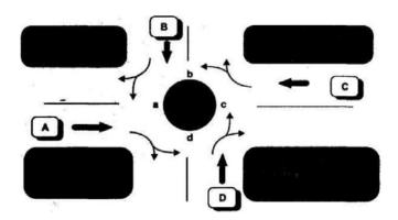
При построении модели в качестве условия выезда на кольцо следует использовать условие отсутствия автомобилей в ближайшем левом секторе кольца. Например, транспортное средство, подъехавшее к кольцу с направления A, может выехать на кольцо только при отсутствии автомобилей в секторе ab, транспортное средство, подъехавшее к кольцу с направления B, может выехать на кольцо только при отсутствии автомобилей в секторе bc и т. д. Время проезда одного сектора кольца 8±3 сек.
