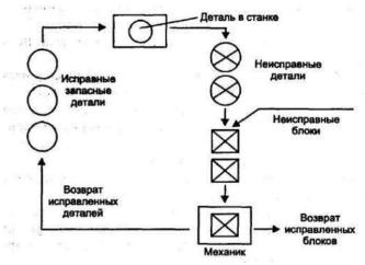
Время работы детали распределено нормально со средним 350 ч и стандартным отклонением 70 ч. Съем детали со станка занимает 4 ч, время установки новой детали — 6 ч. Время ремонта детали распределено нормально со средним 8 ч и стандартным отклонением 0,5 ч.
