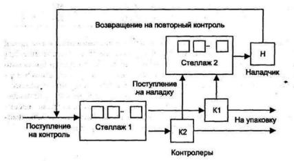
Телевизионные приемники попадают на станцию контроля каждые  $5\pm 2$  мин. На станции работают два контролера, каждому из них на проверку телевизора нужно  $9\pm 3$  мин. Примерно 85% телевизоров проходят проверку успешно и попадают в цех упаковки, остальные 15% попадают на участок наладки, на котором работает один рабочий-наладчик. Наладка занимает 30+10 мин.
