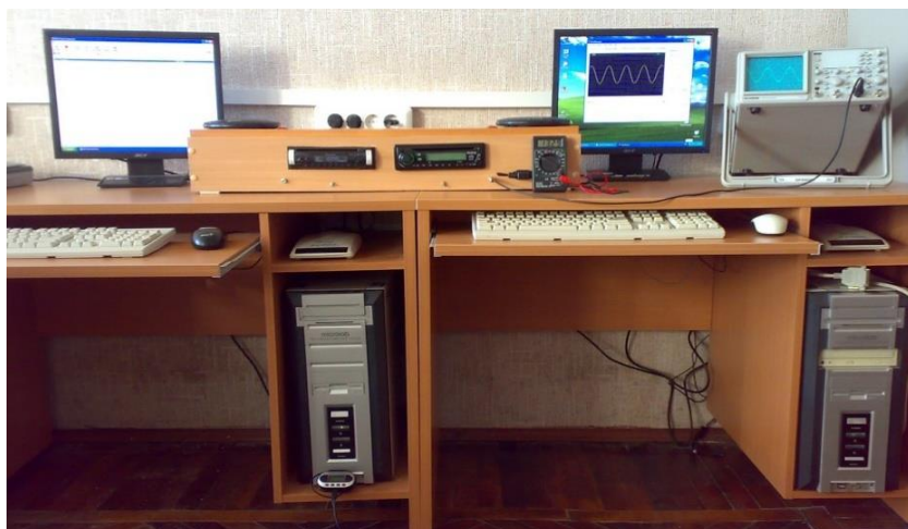
Рис. 12. Рабочая установка по технической диагностике радиоманитол
