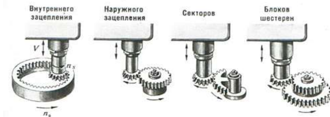
Рис. 4.1. Схема нарезания прямозубых колес на зубодолбежном станке
