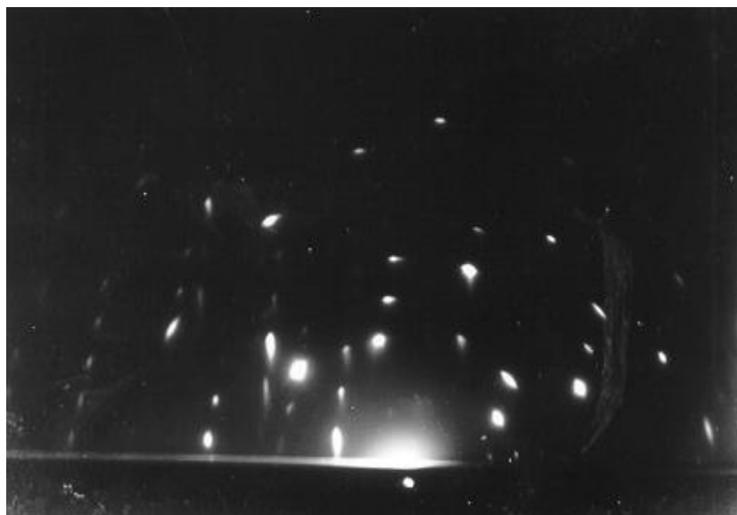
Рис. 3.13. Электронограмма на отражение от пленки ZnO на чистой поверхности (0001) Al_2O_3 .
