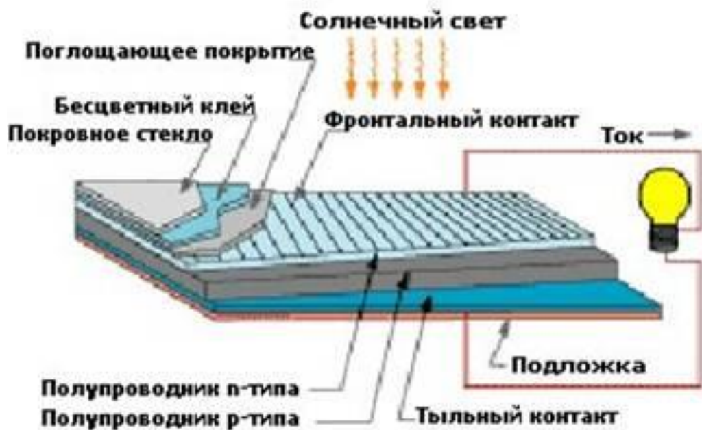
Рис. 4.6. Конструкция фотоэлемента
