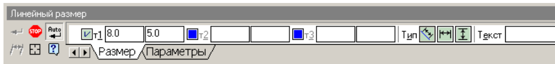
Рис. 2.7. Вид Панели свойств при нанесении линейных размеров.
