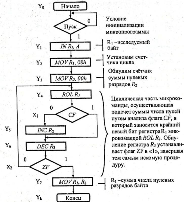
Рис. 6. Граф микропрограммы подсчета числа «нулей» в byte.
