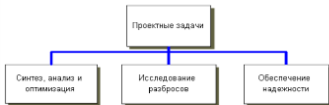
Рис. 16. Структурная схема заключительного этапа автоматизированного проектирования РЭС
