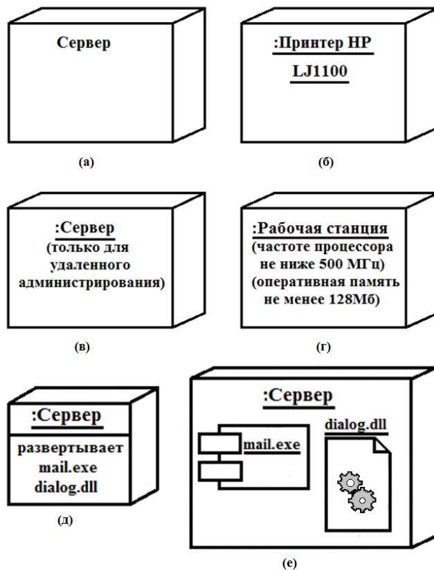
Рис. 4.10. Графические изображения узлов на диаграммах развертывания
