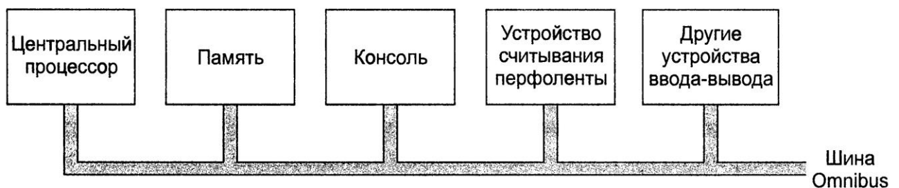
Рисунок 1.3 - Архитектура ЭВМ с общей шиной
