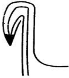
Рис. 32. Углошов из 7 слоев жести
