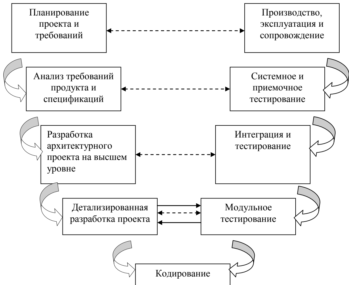
Рис. 4.5. V –образная модель жизненного цикла разработки ПО.
