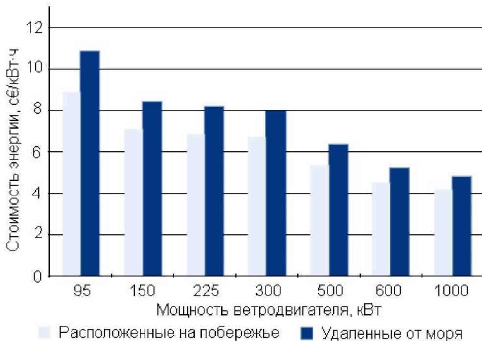
Рис.23. Зависимость стоимости электроэнергии от мощности ветродвигателей при их расположении на побережье и вдали от моря
