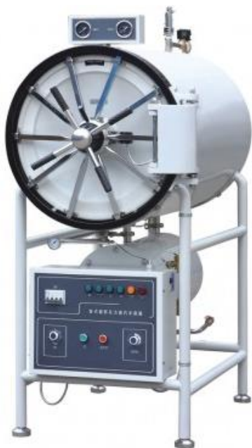
Рисунок 5.5 -Автоклав горизонтальный, малогабаритный
