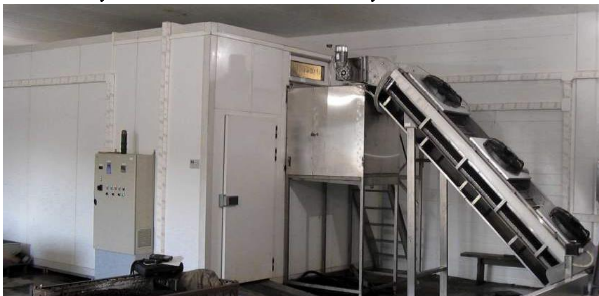
Рисунок 7.5 - Флюидизационный скороморозильный аппарат
