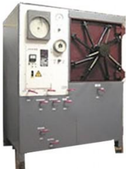
Рисунок 5.4- Автоклав горизонтальный ТМП-200
