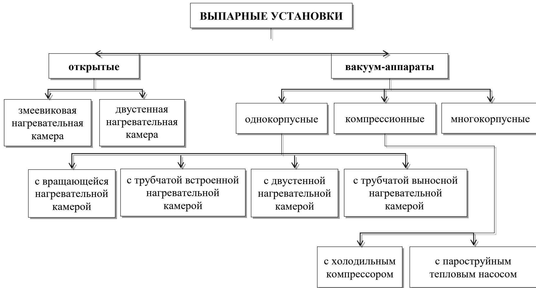
Рисунок 4.1 - Классификация выпарных установок
