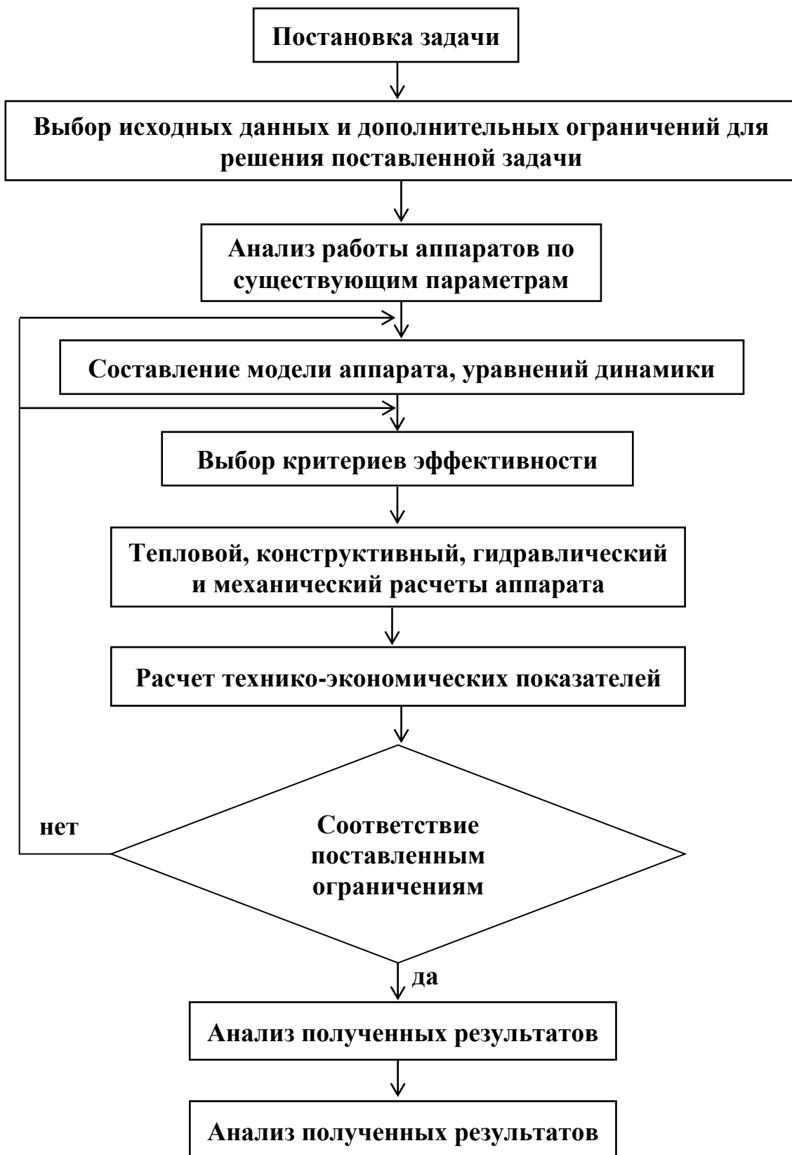
Рисунок 1.1- Блок-схема теплотехнического расчета теплообменника на ЭВМ
