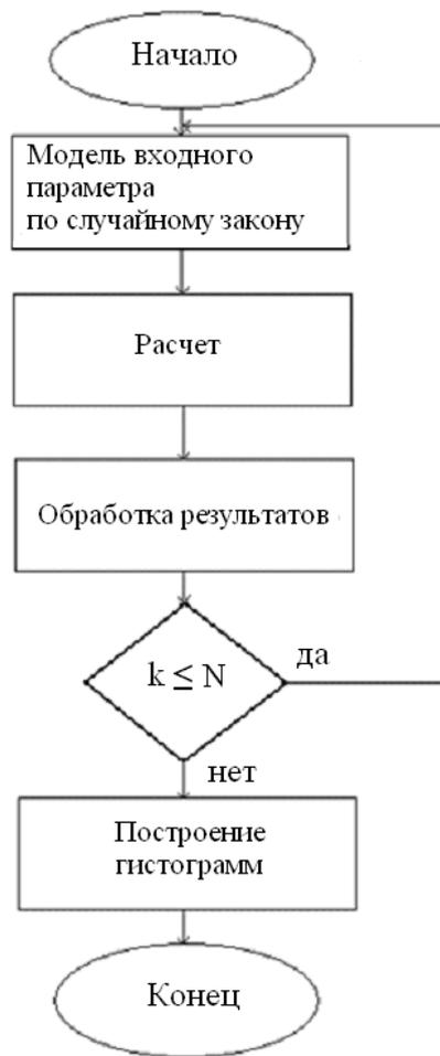
**Рис. 7.6.** Структурная схема алгоритма статистического анализа:
