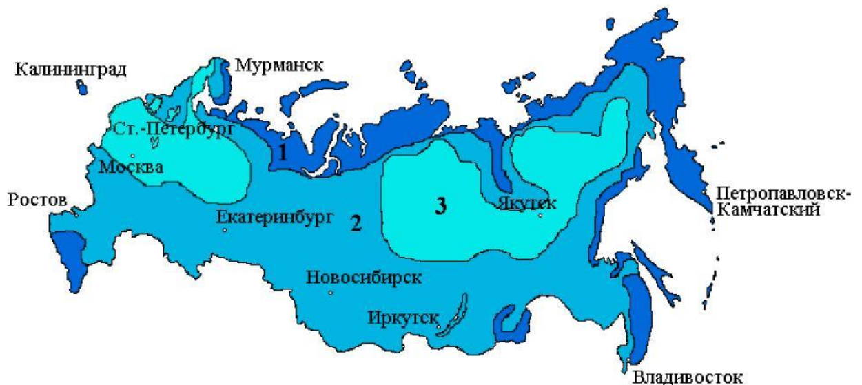
Рис.20. Карта ветроэнергетических ресурсов России. Цифрами обозначены зоны со среднегодовыми скоростями ветра: 1 – выше 6 м/сек; 2 – от 3,5 до 6 м/сек; 3 – до 3,5 м/сек.
