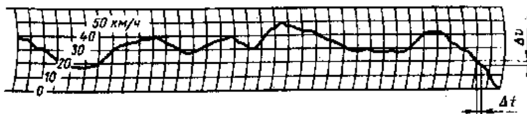
Рис. 3.6. Образец непрерывной автоматической записи скорости движения автомобиля-лаборатории в транспортном потоке на городской магистрали: \Delta v — изменение скорости за время \Delta t
