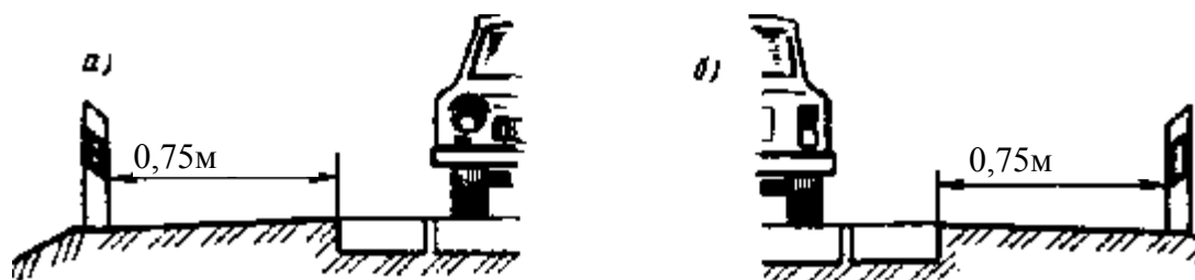
Рис. 6.1. Схема размещения направляющих столбиков на дороге левой (а) и правой (б) сторон
