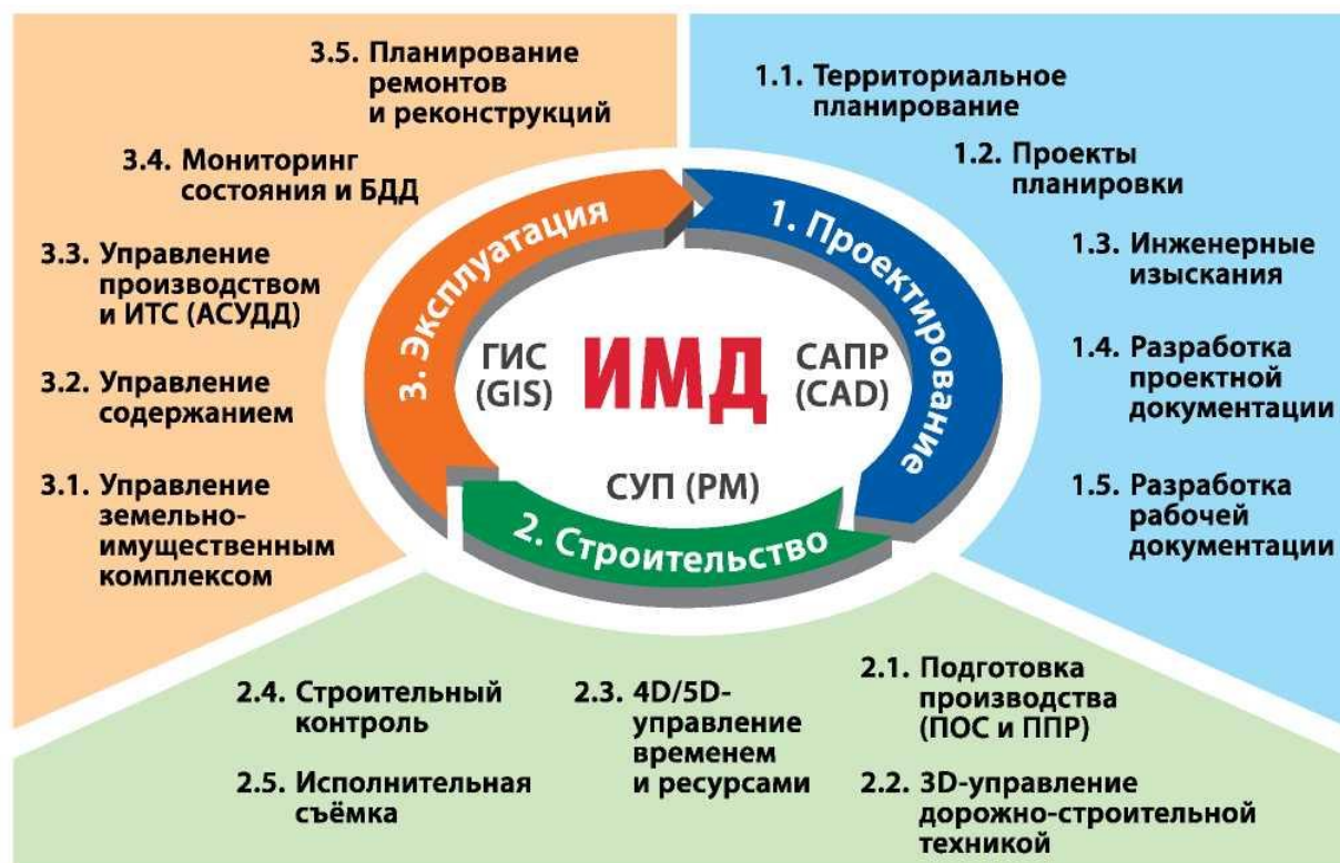
Рис. 4.12. ИМД в графическом виде, стадии ЖЦ дороги и сопутствующие им процессы.
