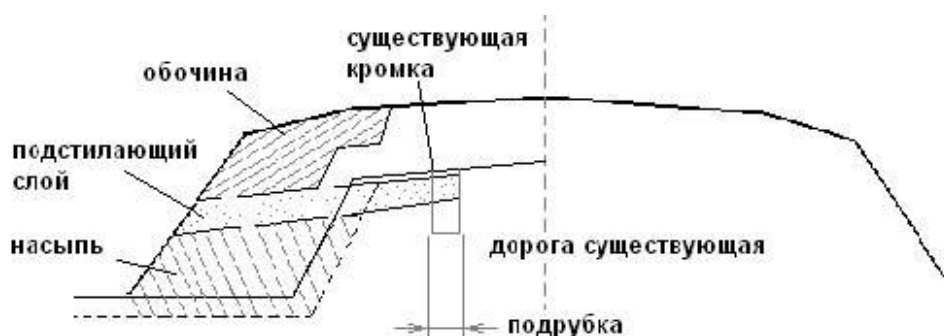
Рис.4.3 Срезка существующей обочины для устройства необходимого уширения проезжей части
