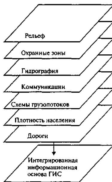
Рис. 5.1. Пример совокупности тематических слоев, как интегрированной основы графической части ГИС
